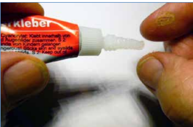
Bild 6: Fingerschutz mit Kleberbeschichtung
