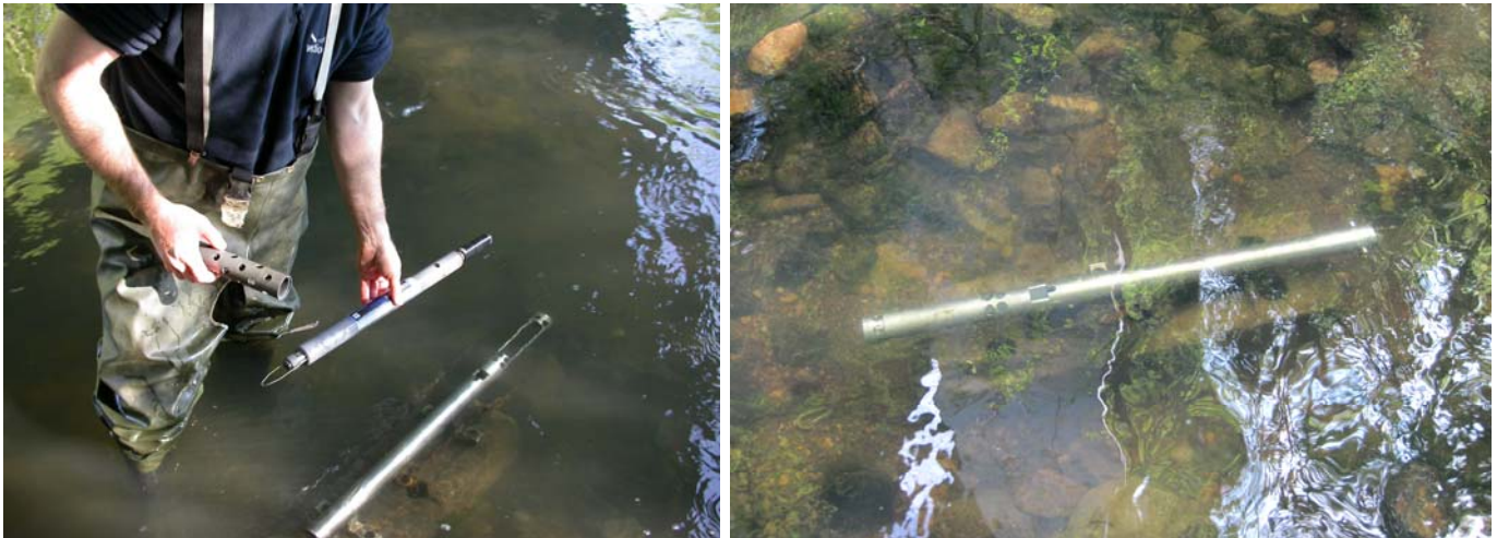
Abb. 4: Sonden zur Messung von Sauerstoffgehalt, Trübung und Temperatur im Gewässer. Die Sonden sind auf Betonblocks montiert die über eine Kette am Gewässerrand gesichert sind.
