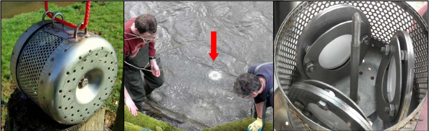
Abb. 1: POCIS – Passiv-Sammler für die Expositionsabschätzung von Pestiziden im Gewässer. Links sieht man den POCIS-Käfig welcher mit drei Membranen ausgestattet ist (Bild rechts) an welchen die Schadstoffe anhaften; in der Mitte die Erscheinung des POCIS im Gewässer (roter Pfeil). Die POCIS-Käfige werden durch ein Seil am Ufer befestigt, das Seil wird mit Steinen beschwert.
