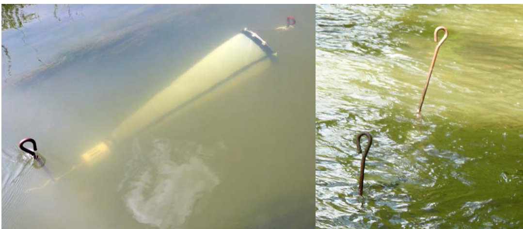
Abb. 2: Schwebstoff-Netze: Links die Erscheinung im Gewässer, rechts Spiralanker zur Befestigung der Netze um strömungsbedingte Turbulenzen und ein Abrutschen auf den Gewässergrund zu vermeiden.
