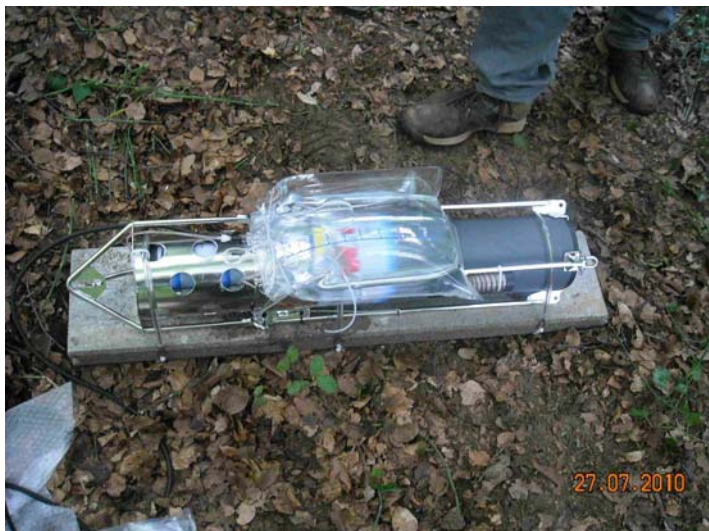
Abb. 5: Nährstoffsonde WIZ: Sie ist in der Lage in hoher zeitlicher Auflösung Ammonium, Nitrit, Nitrat und o-Phosphat zu messen
