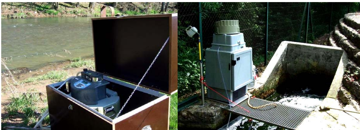
Abb. 3: Automatische Probenehmer zur Messung regenabhängiger Schadstoffimmisionen aus diffusen Quellenn
